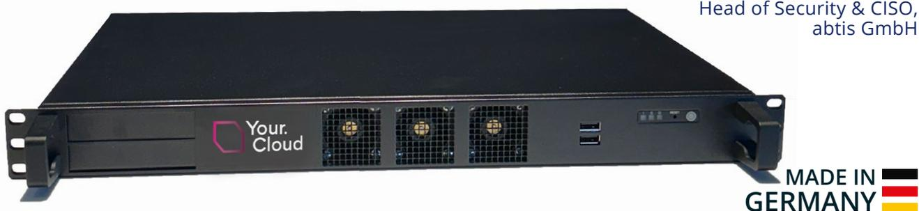
Auch das Chassis des IoT-Gateways ist für industrielle Umgebungen optimiert. Die Pulverbeschichtung verleiht ihm einen hohen Korrosionsschutz, gute elektrische Isolationseigenschaften und zusätzliche Stabilität gegen mechanische Belastungen.
