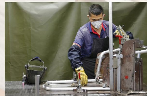
Das Metallchassis des Easy Shopper entsteht zu 100% in Handarbeit in unserem Werk in Suining. Dort erfolgt auch die Assemblierung zum fertigen ODM-Produkt.
