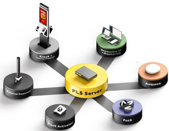
Der Server Hub ist das Herz der PLS-Infrastruktur. Über die Antennen empfängt er Daten von den Kioskterminals, den internen und externen Dispensern sowie den Pucks und verwaltet sie durch fortschrittlichste Algorithmen. Der Server Hub bietet eine JSON-Schnittstelle zur nahtlosen Integration in Ihr POS.
